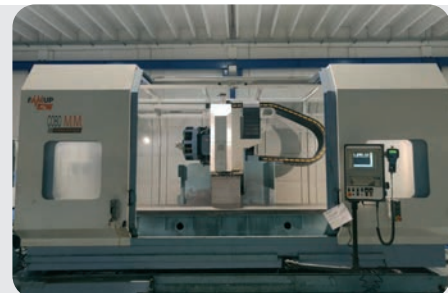
Centro di lavoro a montante mobile FAMUP-OMZ MOD. COBO MM 3000 anno 2002, CN Selca, tavola: 3450 x 600 mm, corse: X 3000 mm, Y 600 mm, Z 500 mm, mandrino ISO 40, vel. 40-8000 giri/min, potenza 11 Kw
