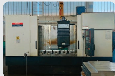
Centro di lavoro a montante mobile MAZAK MOD. VTC-200C-II anno: 2013, matr.: 243678/I, C.N. Mazatrol 640M, tavola: 2000 x 510 mm, peso ammesso: 1000 Kg, corse: X 1660 mm, Y 510 mm, Z 510 mm
