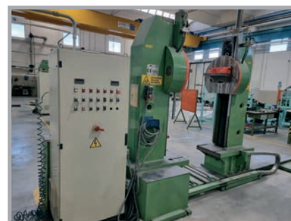
Montastampi A.U. mod. M70 lunghezza max stampo 2800
