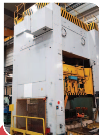
PRESSA MECCANICA SCHULER 600 TON TAVOLA MOBILE 3350 X 2130 mm CORSA 600 mm – LUCE CBRA 1100 mm
