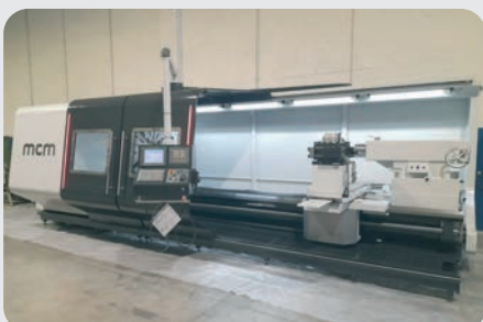
Tornio MCM MOD. ATL HEAVY PLUS anno 2014, matr. 1759, ore di accensione: 13020, ore di lavoro: 12250, CNC FANUC 0i-TC, altezza punte sul banco: 700 mm, distanza tra le punte: 4000 mm, motore: 37 Kw
