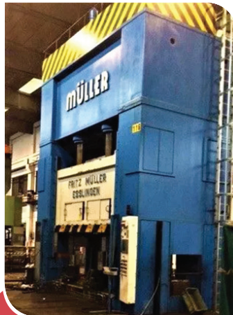
PRESSA OLEODINAMICA MULLER 1600 TON TAVOLA 3500 X 2740 mm CORSA 1400 mm – LUCE 2000 mm
