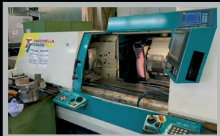
Rettificatrice cilindrica (Cylindrical Grinding Machine) TACHELLA ELEKTRA EVO 1018 MPC , h punte 180 x 1000 mm, mandrino int. 30.000 rpm, vasca filtraggio a carta, balance system, interfaccia EVO-Fanuc 21i, anno 2004
