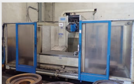
Fresatrice a banco fisso ALESAMONTI modello BFM0 con controllo numerico SELCA S3045, dimensioni tavola mm 1800 x 750, corse X/Y/Z 1600/800/1000 mm, testa bimandrino ISO 50, cambio gamma automatico, evacuatore trucioli, marchio CE
