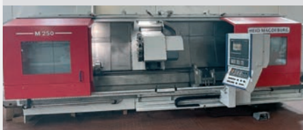
Tornio CNC MAGDEBURG modello M250 controllo SIEMENS 840C, Ø max tornibile / lunghezza massima tornibile 470 / 3030 mm, attacco mandrino ASA8", foro mandrino 90 mm, mandrino autocentrante diametro 315 mm, torretta 12 posizioni per ut. motorizz. VDI50, asse C su mandrino principale, lunetta idr. SLU 5, con presa da 50 a 310 mm, marchio CE
