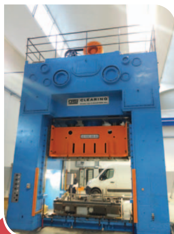
PRESSA MECCANICA CLEARING 500 TON TAVOLA 2746 X 1524 mm CORSA 762 mm – LUCE CBRA 1100 mm
