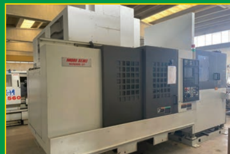
Centro di lavoro verticale MORI SEIKI NV 5000, corso X=1020 mm, Y=510 mm, Z= 510 mm SIMONINI - Tel. 045/7144034 - (pag. 20-21)
