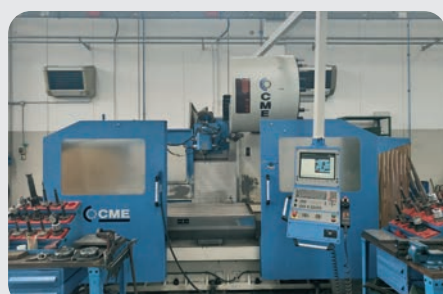
Fresatrice CME FS1 anno 2006, numero di serie FS-370, superficie tavola 1.600 x 850 mm, corsa asse X 1.500 mm, corsa asse Y 1.000 mm, corsa asse Z 1.000 mm, avanzamenti 0-20.000 mm/min
