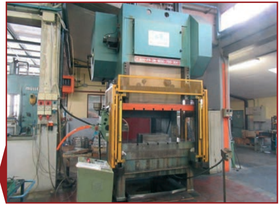
Pressa collo di cigno, a 2 bielle COPRESS P 200 FR 2B 200 TON, piano 1.600x750, corsa 35-200
