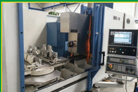
Centro intestatrice AXA HFB 1P. CNC SIEMENS 840D, Ø 140x1250, tav. rotante 180°, cambio ut. B.M. - Tel. 011/4031124 - (II cop-pag. 3-4)
