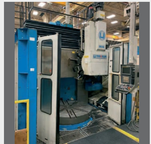
Tornio verticale TOS SKIPI 16, asse C, utensili mot., Ø plateau 1600, Ø tornibile 2000, altezza tornibile 1500, rotazione plateau 400 giri/min, cambio utensili 15 posti, CNC FANUC 16IT
