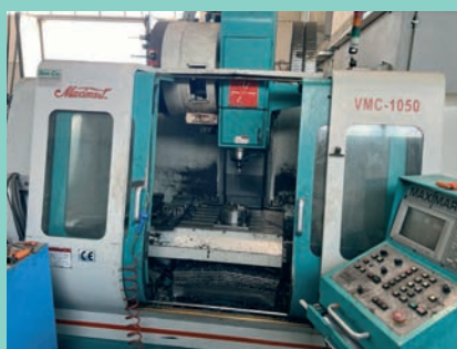
Centro di lavoro MAXIMART 1050 1050x550x550 8000 giri, mag. 24 utensili tavola 4 asse, CNC Mitsubishi con numerosi coni usati
