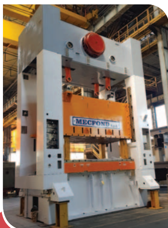
PRESSA MECCANICA MECFOND 600 TON TAVOLA MOBILE 3950 X 2300 mm CORSA 600 mm – LUCE CBRA 1500 mm
