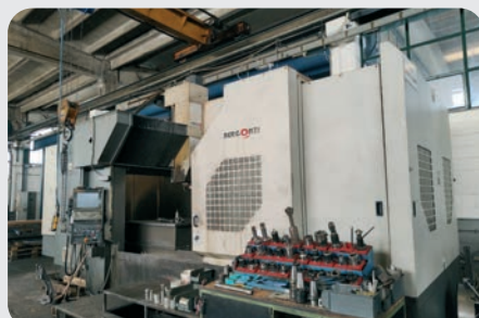
Centro di lavoro BERGONZI MOD. COSMOS 30 a portale, anno 2009, CNC SELCA 400, corse: X 3000 mm rapido 12000 mm/min, Y 2000 mm rapido 12000 mm/min, Z 700 mm rapido 12000 mm/min
