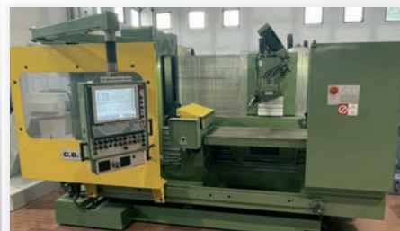
Centro di lavoro verticale CB FERRARI modello A17 con controllo SELCA S4000, corse X/Y/Z 1050/520/420 mm, testa tiltante +/- 90°, ISO 40, RPM 10-5000, magazzino utensili a 21 posti, righe ottiche sui 3 assi, marchio CE, COMPLETAMENTE REVISIONATA COME NUOVA
