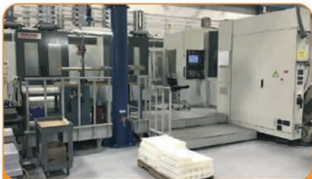
Centro di lavoro orizzontale MORI SEIKI NH 6300 DCG - matr. 2555
