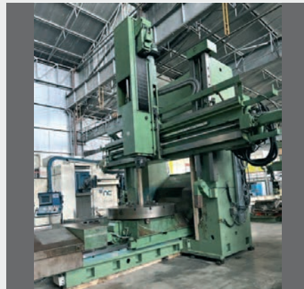
Tornio verticale PENSOTTI NDM 160 , asse C, asse Y, utensili motorizzati, diam plateau 1800, diam tornibile 2600, altezza tornibile 1800 (2200), nr 2 cambio utensili a tornire e a fresare, capacità di fresatura 2000 x 2000, CNC ICEM
