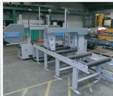
Segatrice a nastro MEBA modello 510 A - 1300 automatica, completa di rulliera di carico, capacità di taglio fino a diametro 510 mm
