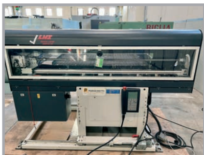
Caricatore di barre LNS mod. QUICKLOAD SERVO 3 diametro 6-120, L=1600
