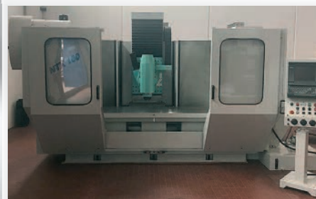
Centro di lavoro a montante mobile GOGGIO modello MTX 160 con controllo SELCA S4045D, volantino elettronico, dimensioni tavola mm 1900 x 650, corse assi X/Y/Z 1600/750/700 mm, elettomandrino ISO 40 15000 RPM, magazzino utensili a 24 posti, testa tiltante +/- 100° index 1°, evacuatore trucioli, righe ottiche, marchio CE, REVISIONATA!
