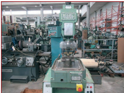
Filettratrice VIGEL M65/T tavola rotante 8 posizioni M10x1,5
