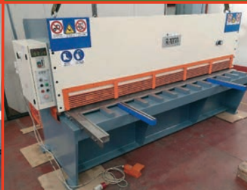
Cesoia GATTI 3000x4 mm. idraulica registro posteriore motorizzato
