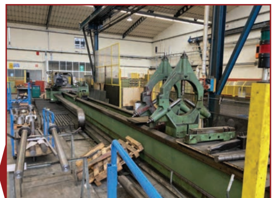
Tornio parallelo PONTIGGIA SM/D CNC ECS, 500 x 12000, Ø 665 sul carro, kW 37
