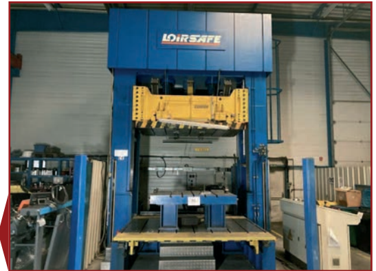
Provastampi LOIRE SAFE ESSM 200 200 TON, piano 2500x1500, corsa 1600, piani estraibili e ruotabili, anno 2001
