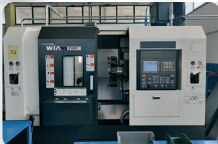
Tornio a CNC HYUNDAI MOD. WIA L 2100Y anno 2016, max \varnothing tornitura 335 mm, max lunghezza di tornitura 455 mm, \varnothing capacità della barra 65 mm, dim. mandrino 76 mm, velocità mandrino 4500 rpm
