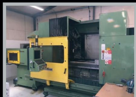
Centro di lavoro (Machining Center) C.B. FERRARI B18 , 1400 x 520 x 420 mm, CNC E560, 60 utensili, 18.000 rpm, 5 assi
