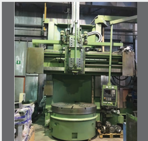
Tornio verticale PENSOTTI NT 160 , diametro plateau 1600, diametro tornibile 2050, corsa ram 1500, altezza sotto traversa 2000, sezione ram 230 x 250, cambio utensili 12 posti, cnc SIEMENS 840 D
