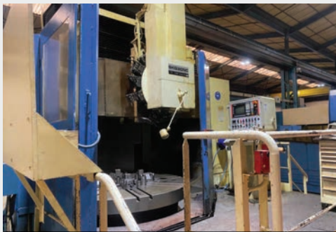
Tornio verticale TOS SKQ 20 , diam plateau 2000, diam tornibile 2200, altezza max pezzo 1260, cambio utensili 15 posti, CNC NUM 1040
