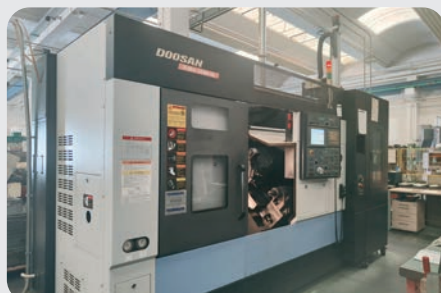
Tornio DOOSAN MOD. PUMA 240M-GL anno 2007, N/S P24M3314, Ø tornitura 300 mm, lugh. tornitura 513 mm, pass. barra Ø 65 mm, corse: X 205 mm rapido 24 m/min, Z 580 mm rapido 30 m/min
