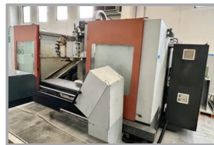
Centro di lavoro EIKON mod. MV3 corse 1800x500x430, CNC FANUC 21i
