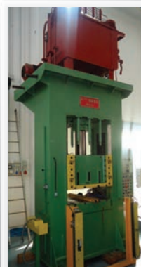
Pressa idraulica NAVA modello 2MI 100/50N potenza 100 Ton, dimensioni tavola 850 x 600 mm, MACCHINA IN PERFETTE CONDIZIONI
