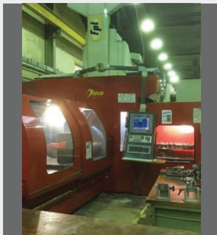
Fresatrice a portale 5 assi FPT DINO, 2300 x 1600 x 1000, ATC 30 pos, 2 teste: 10.000 giri e 34.000 giri, anno di costruzione 2003
