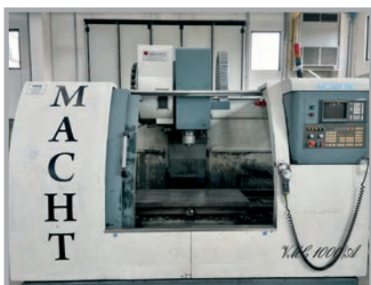
Centro di lavoro MIND mod. MACT 1000A corse 1020 x 610 x 610, CNC FANUC
