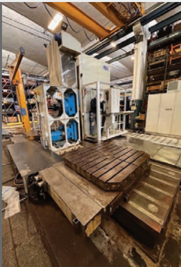
Fresatrice a montante mobile MONTI M 20, corse: 5000 x 1000 x 2000, 2 tavole girevoli, cambio utensili 60 posti, testa automatica ortogonale con 2 uscite, 4000 giri/min, CNC HEIDENHAIN TNC 430
