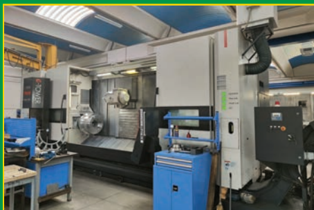
Tornio a cnc multitasking MAZAK mod. INTEGREX E500 H II, anno 2008.11, C.N. Mazatrol Matrix CENTRO MACCHINE UT. - Tel. 035/4491399 - (pag. 14-15)
