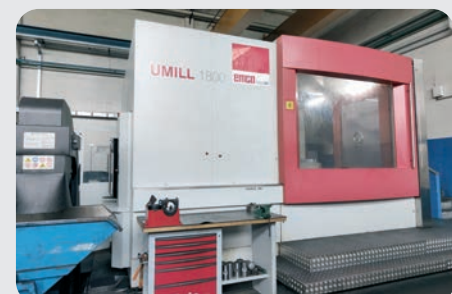
Fresatrice EMCO-MECOF MOD. UMILL 1800 5 assi, anno 2016, CNC Heidenhain, corsa asse trasversale 1800 mm, corsa asse longitudinale 2150 mm, avanzamenti 60m/min
