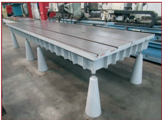
Piano 4.950x1.500 di riscontro colonne di sostegno, livellamento dall'alto
