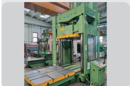
Pressa prova stampi REIS MOD.TUS 130-100 anno 1999, altezza installazione 1400 mm, tavola 1600x1300 mm, corsa slitta 1500 mm, vel. traslazione slitta: 200 mm/s, capacità di carico max: 12000 Kg
