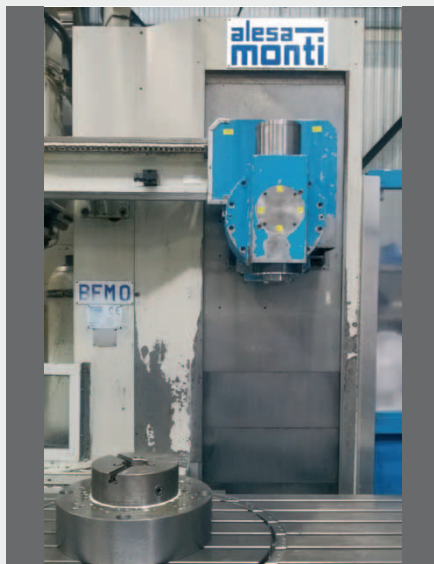
Fresatrice banco fisso MONTI BFMO TGF, testa automatica, con tavola girevole integrata, corse: 2000 x 800 x 1000, tavola girevole diam 800 mm, cambio utensili 30 posti, 4000 giri/min, CNC HEIDENHAIN TNC 530
