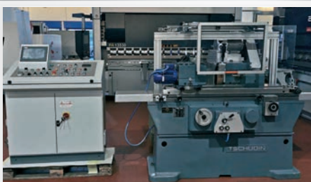
Rettificatrice per esterni TSCHUDIN HTG 632 altezza punte 110 mm, distanza utile 550 mm, completamente revisionata con sistema di programmazione ciclo display Touch Screen
