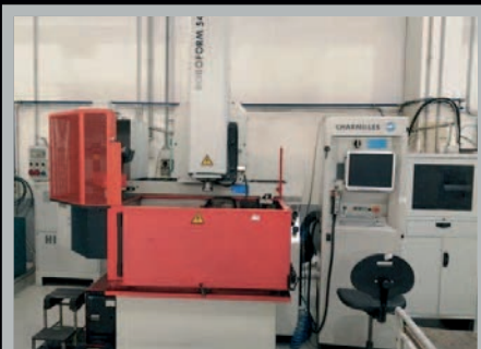
Elettroerosione a tuffo (EDM Machine) CHARMILLES ROBOFORM 54P , 600 x 400 x 450 mm, asse C, cambio elettrodo 24 posti, refrigeratore dielettrico
