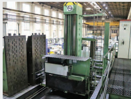
Foratrice KOLB HTB 3 , corse: 5000 x 3000 x 1150+500,3 mandrini, piani stolle e squadre, cnc SIEMENS 550, attacco BTA e PUNTA CANNONE
