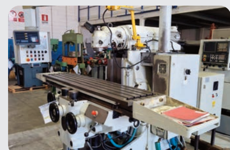
Fresatrice HURON tavola: 2000 x 460 mm, corse: asse X 1500 mm, asse Y 500 mm, asse Z 500 mm, mandrino: ISO 50
