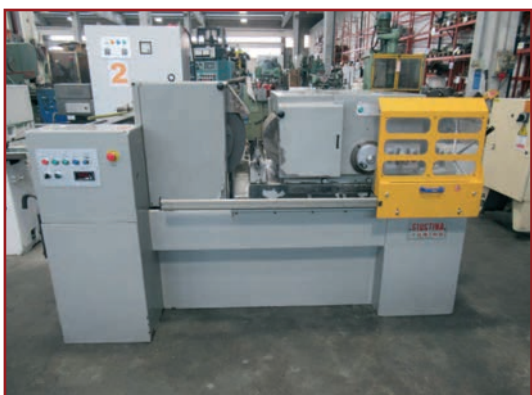
Rettifica senza centri GIUSTINA R 150 C diametro min-max 1,5-150, fascia mola 355
