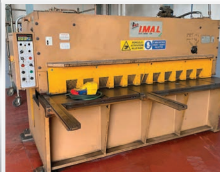
Cesoia idraulica IMAL modello CCO25 4 programmatore del registro posteriore, regolazione inclinazione lama
