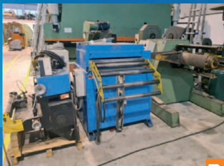
LINEA DI ALIMENTAZIONE PER PRESSA CON PLC DIMECO 1676/F
