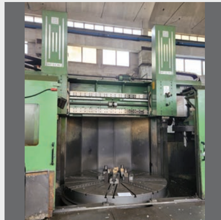
Tornio verticale SAMU RST 32 , 2 ram, diam plateau 3000, diam tornibile 3300, altezza tornibile 2300, 2 cambio utensili, CNC SIEMENS 840 D
