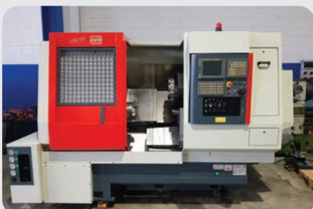
Tornio a CNC ANGELINI MOD. OSCAR anno: 2010, matr.: 1534 R 21 MB F, C.N. FANUC 21i-TB, passaggio barra: \varnothing 65 mm, corse: X 270 mm rapido 24 m/min, asse Z 720 mm rapido 32 m/min
