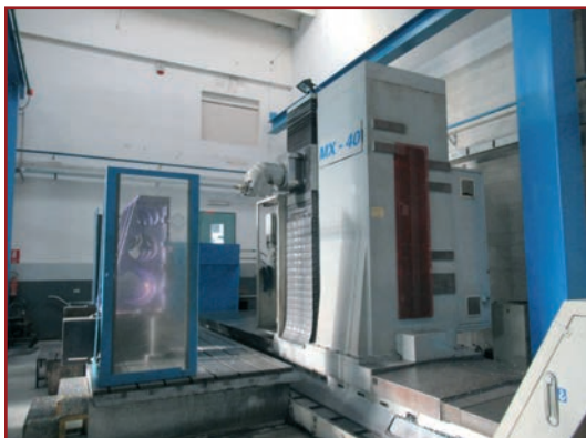
Fresatrice GOGLIO MX 40 X=4000 a montante mobile, ISO 50, 4000 rpm, 24 kW, CNC Selca, anno 2003
