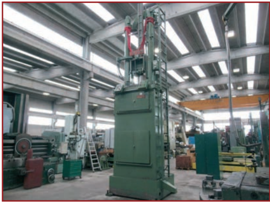
Brocciatrice per interni VARINELLI BV-40 40 TON, corsa 2000, da 1 a 3 stazioni
