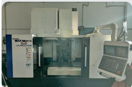
Centro di lavoro HYUNDAI MOD. F500/40 PLUS anno 2016, CN FANUC, corse: asse X mm 1.060, asse Y mm 510, asse Z mm 635, area di lavoro dim. della tavola mm 1.200x500, peso max del pezzo lavorabile kg 800
