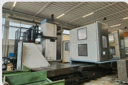
Alesatrice DOOSAN MOD. DB250CM anno 2008.06, N/S DB250CM, CNC Fanuc 18 IMB, ore di accensione 10.745, corse: assi X 3000 Y 2000 Z 1600 (montante) W 500, tavola 1800 x 1600 portata 15000 kg
