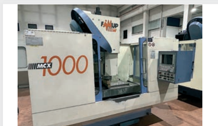
Centro di lavoro verticale FAMUP MCX 1000 con controllo SELCA 3045, dimensioni tavola mm 1300 x 520, corse X/Y/Z mm 1000/480/470, mandrino ISO 40, velocità rotazione RPM 8000, magazzino 24 posti, marchio CE
