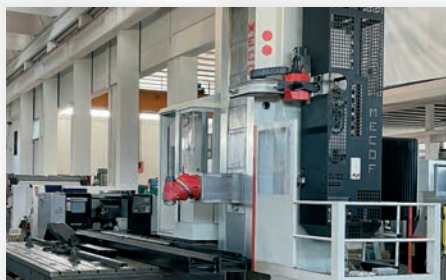
Fresatrice a m. m. MECOF AGILE M3 HEIDENHAIN TNC530, volantino elettr., piano STOLLE 14000 x 2000 mm, corse X/Y/Z 12000/1500/2800 mm, testa bir. aut. ISO 50, vel. rotazione mandr. 4000 RPM, mag. ut. 60 posti, predisposizione impianto refrigerante ad alta pressione attraverso il mandr. 20 bar, evacuatore trucioli a catena, pedana operatore mobile, CE
