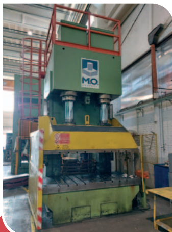
PRESSA OLEODINAMICA M.O. 300 TON TAVOLA 2500 X 1200 CORSA 800 mm – LUCE MAX. 1200 mm
