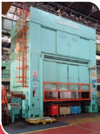
PRESSA MECCANICA MECFOND 1500 TON TAVOLA MOBILE 5000 X 2700 mm CORSA 500 mm – LUCE CBRA 1300 mm
