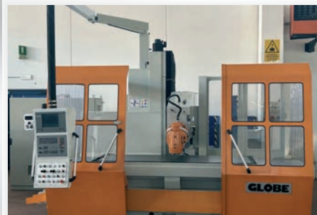
Fresatrice a banco fisso GLOBE TRADE modello U2100 CNC con controllo HEIDENHAIN TNC 430M, dimens. tavola 2500 x 1000 mm, corse X/Y/Z 2100/1000/1300 mm, testa birotativa automatica orizzontale/verticale ISO 50, velocità rotazione mandrino 4000 RPM, evacuatore trucioli, marchio CE
