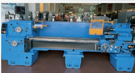
Tornio parallelo POTISJE PA 300 x 2000 visualizzatore GIVI MISURE montato sui 2 assi, rapidi di spostamento, REVISIONATO
