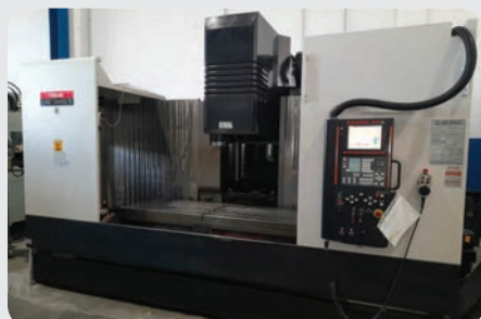
Centro di lavoro verticale MAZAK VTC 300C II anno 2005, N/S 179097, C.N. Mazatrol 640M, tavola 2.000 mm x 760 mm, peso max ammesso 1.400 kg., corse: X 1.740 mm, corsa Y 760 mm, corsa Z 660 mm
