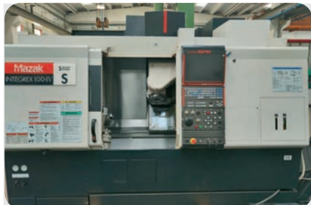
Tornio MAZAK MOD. INTEGREX 100-IVS anno 2009-12, ore di taglio 3350, CN Mazatrol Matrix, passaggio barra Ø 61 mm, corse: X 410 mm, Y 140 mm, Z 805 mm, mandrino A2-5, vel. 6000 giri/min
