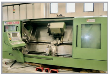
Tornio cnc GRAZIANO mod. G7700 D=400, L=2000, asse C+motorizzati
