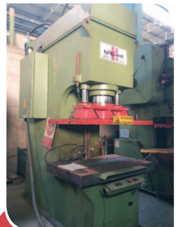
PRESSA OLEODINAMICA GIGANT 150 TON TAVOLA 1200 X 800 CORSA 650 mm
