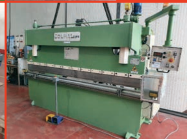
Pressa piegatrice COLMAL 3000x70 Ton. registro posteriore con puntalini manuali
