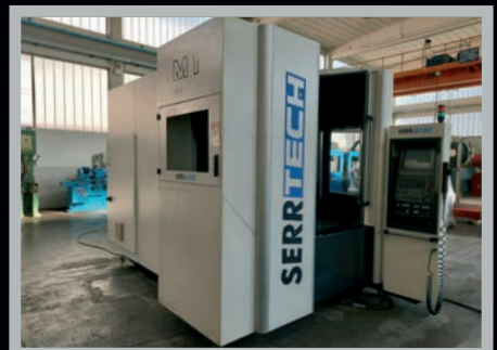
Centro di lavoro (Machining Center) SERRTECH M1 , 1000 x 600 x 600, 30 utensili, 12000 rpm, HEIDENHAIN i530
