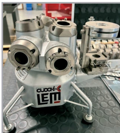
Affilatrice per frese CUOGHI mod. LEM diametro 4-20
