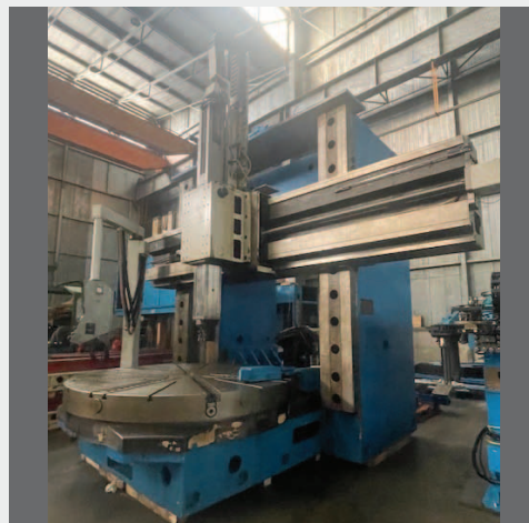
Tornio verticale TOS SKA 25. Diam plateau 2500, diam tornibile 2920, altezza tornibile 1940, corsa RAM 1560, cambio utensili 32 posti, CNC SIEMENS 840 C
