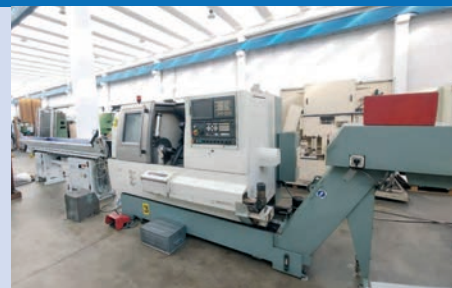
Tornio CTX 300 con asse Y e utensili motorizzati
