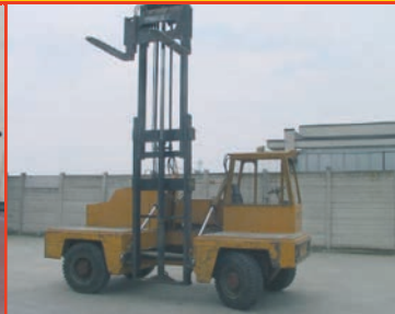
Carrello elevatore laterale SCS portata 30 q.li alzata mm. 4000, idroguida, diesel
