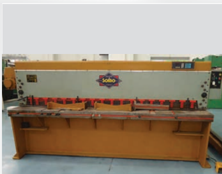
Cesoia meccanica SOMO modello SC 30/4 con programmatore registro posteriore
