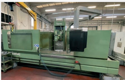
Fresatrice a banco fisso SACHMAN modello TS 10 HS con controllo SELCA S3045, dimensioni tavola mm 2200 x 700, corse assi X/Y/Z mm 2000/1075/900, testa birotativa automatica orizzontale/verticale ISO 40, velocità rotazione RPM 4000, 3 volantini elettronici, marchio CE
