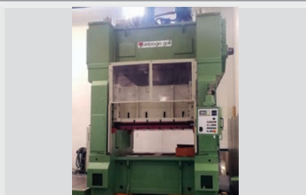
Pressa meccanica a doppio montante AMBROGIO GALLI modello 30 MTL 205-150-30/R potenza 315 Ton, piani 2050x1500 mm, in perfette condizioni, marchio CE
