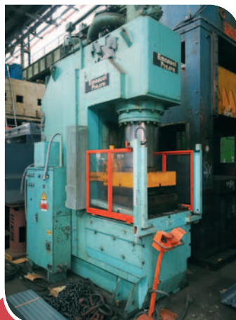
PRESSA OLEODINAMICA EMANUEL 300 TON DIMENSIONE TAVOLA 1000 X 1000 mm CORSA 600 mm
