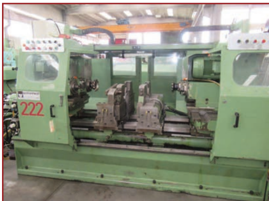
Centro intestatrice TOVAGLIERI M 210 Ø 180x1500 idraulica 2+2 teste contrapposte
