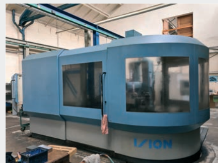
Foratrice IXION TLF 1004 , diam di foratura 32, corse: 2000x800x2000, tavola 1000 x 1500, mandrino di fresatura ISO 40, cambio ut. 24 pos, CNC MITSUBISHI 530
