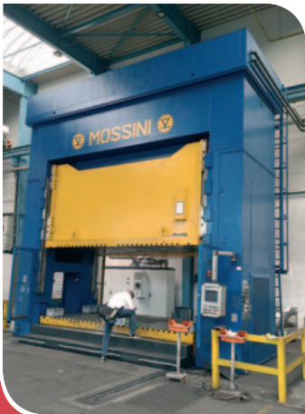
PRESSA OLEODINAMICA MOSSINI 1600 TON TAVOLA 5000 X 2480 CORSA 1500 mm – LUCE MAX 2000 mm
