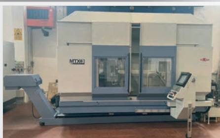
Centro di lavoro EIKON MTX 3 a m. m., CN SELCA 4045D, testa tiltante in continuo +/- 100°, dim. tavola mm 2000 x 700, corse X/Y/Z mm 2000/700/900, mandrino ISO 40 12000 RPM, cambio ut. RANDOM con mag. a 30 posti, tavola CNC 4° asse TSUDAKOMA RN200, impianto refrigerante alta pressione 50 bar attraverso il mandr., marchio CE
