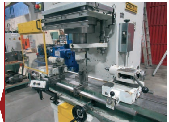
Pressa a raddrizzare GALDABINI RPRS 80 TON, idraulica, corsa 200, banco 260x2200
