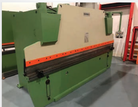
Pressa piegatrice GAMAC modello 60 x 4000 regolazione profondità di piega e registro posteriore motorizzato
