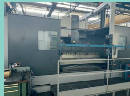
Centro di lavoro MORI SEIKI MV 1003 CNC MSG501, corse X Y Z 2400, 1020, 800, BT 50 36 utensili, pacchetto stampisti, anno 2002, piani magnetici, coni
