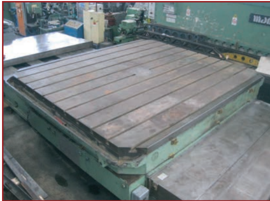
Tavola girevole FRORIEP 120 Tdv. 350/400 120 TON, superficie appoggio 3500x4000, corsa 4000
