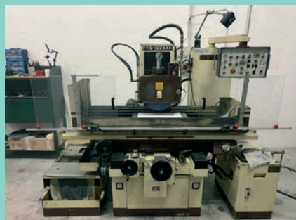
Rettificata tangenziale CHEVALIER FSG 1224 AD tavola 600 x 300 mm, max. lunghezza di rettificata 610 mm, max. larghezza di rettificata 305 mm
