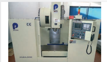
Centro di lavoro verticale PARATEC modello PV 8 con controllo FANUC 18M, dimensioni tavola mm 950 x 500, corse X/Y/Z mm 800/510/560, mandrino BT 40 8000 RPM, magazzino utensili 24 posti, evac. trucioli, marchio CE
