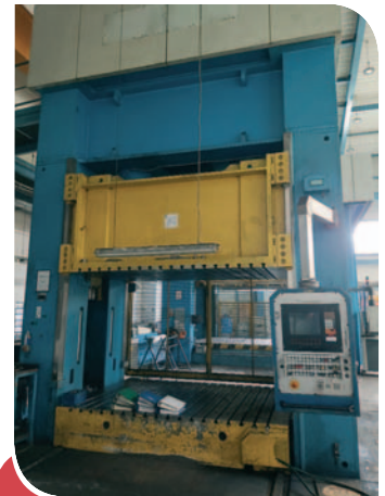
PRESSA OLEODINAMICA SMG 800 TON TAVOLA 3000 X 2100 CORSA 1400 mm – LUCE MAX 2000 mm
