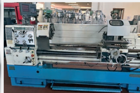
Tornio parallelo ECOCA modello SJ510 x 1500G visualizzatore di quote GIVI MISURE montato sui 2 assi, marchio CE
