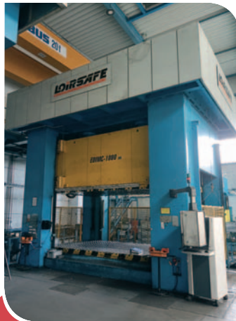
PRESSA OLEODINAMICA LOIRESAFE 1000 TON TAVOLA 5000 X 2500 CORSA 1500 mm – LUCE MAX 2000 mm
