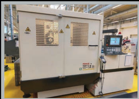
Elettroerosione a filo (EDM machine) FANUC Alpha 1-iB , capacità 550x370x310 mm, CNC Fanuc 180iS-WB, refrigeratore liquido
