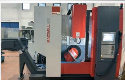
Centro di lavoro a 5 assi EMCO MAXXMILL 500 controllo HEIDENHAIN TNC620, dim. tavola 600x600 mm, corse X/Y/Z 650/550/500 mm, asse B +/- 100°, asse C +/- 360°, mandrino ISO 40 / 15000 RPM, mag. ut. 40 posti, righe ottiche sui 3 assi, impianto refrigerante 20 bar attraverso il mandrino, evac. trucioli, marchio CE, COMPLETAMENTE REVISIONATA
