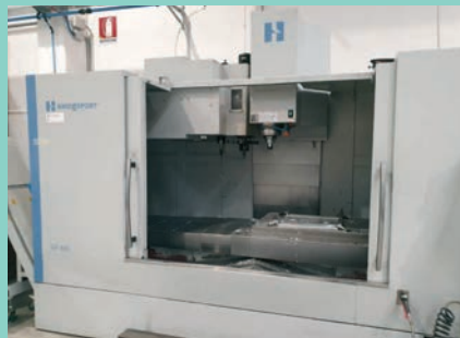
Centro di lavoro BRIDGEPORT GX 1600 anno 2017, CNC Fanuc OiMD, X 1600, Y 700, Z 635, velocità 10000 giri, BT 50, potenza 35 Kw, 32 utensili cts 20 bar
