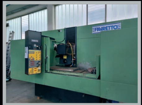
Rettifica tangenziale (Surface Grinding Machine) FAVRETTO MB 100 Auto , 1200x600 mm, inverter mola, piano elettropermanente, interfaccia Favretto Auto-control con cicli di lavoro, Bilanciatore mola semiautomatico
