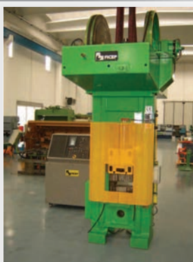
Bilanciere FICEP modello PVS 160 diametro vite 160 mm, forza nominale 270 Ton, in perfette condizioni
