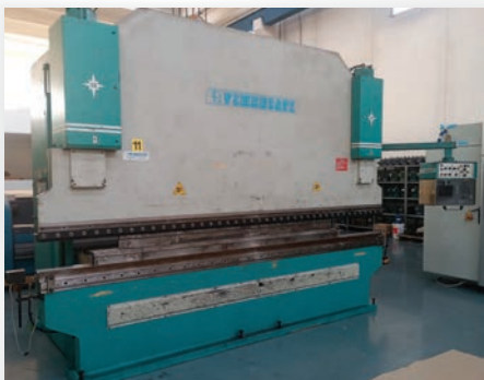
Pressa piegatrice VIMERCATI modello 160 x 4175 con controllo CYBELEC DNC80, 6 assi, compensazione idraulica, marchio CE
