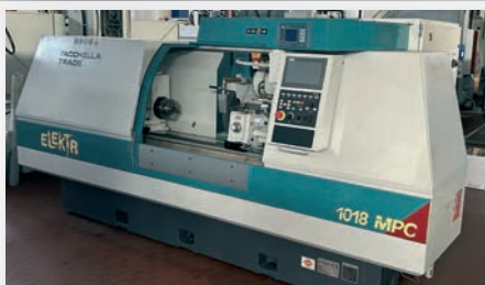
Rettificatrice per esterni TACHELLA mod. ELEKTRA 1018 MPC h. punte 180 mm, distanza punte 1000 mm, sistema orientamento testa portamola MANUALE, doppia mola per esterni, sistema di comando gestito da microprocessore, impianto refrigerante con vasca e pompa con filtro a carta, CE
