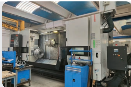
Tornio a cnc multitasking MAZAK MOD. INTEGREX E500 H II anno: 2008.11, C.N. Mazatrol Matrix, Ø tornitura: 820 mm, lunghezza tornitura: 3122 mm, asse Z: 3048 mm, asse X: 870 mm, asse Y: +/- 250 mm, asse C: 0.001°
