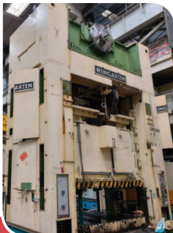
PRESSA MECCANICA LINK DRIVE WEINGARTEN 1000 TON TAVOLA MOBILE 4000 X 2200 mm CORSA 800 mm – LUCE CBRA 1400 mm 4 PRESSE DISPONIBILI
