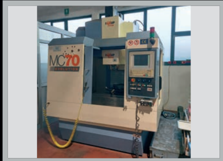
Centro di lavoro (Machining Centre) FAMUP MC 70 Evolution , 700x500x640, 24 utensili, 10.000 rpm, CNC SELCA 3045
