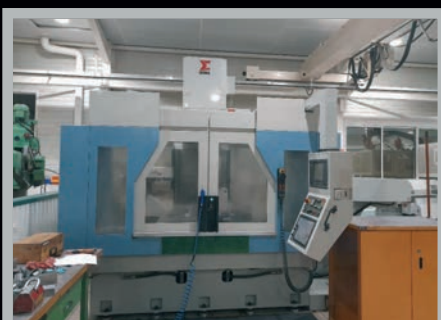
Centro di lavoro (Machining Center) SIGMA MISSION 5 , 1250 x 600 x 685 mm, 12.000 rpm, 21 utensili, HEIDENHAIN TNC426
