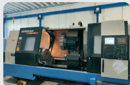
Tornio DOOSAN PUMA 500 anno 2013.07, CNC FANUC, max Ø rotante sul banco mm 900, max Ø rotante sul carro mm 630, max tornibile sul banco mm 700, max lunghezza tornibile mm 1575
