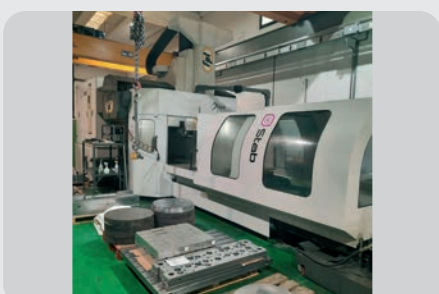
Fresatrice a CNC FPT DINO anno 2002, corse: longitudinale X 2800 mm, verticale Z 800 mm, trasversale Y 1600 mm, avanzamenti rapidi 3500 mm/min, cambio utensili 40 posiz., testa 5 assi in continuo, CNC HEIDENHAIN 426
