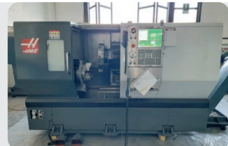
Tornio CNC HAAS MOD. ST 35 Y anno 2017, matricola 3107413, testa del mandrino A2-8, N. utensili 12, diam. 533 mm, velocità di rotazione 3.200 rpm, passaggio barra 102 mm, corse: X 239 mm, Z 826 mm
