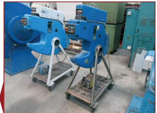
Martellatrice ECKOLD KF 320 formatrice a freddo, capacità in mm, acciaio 2, alluminio 2,5, inox 1,5
