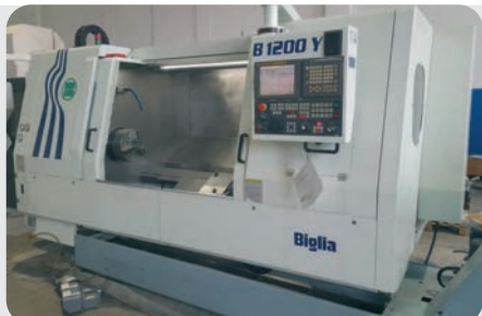
Tornio a CNC BIGLIA MOD. B1200-Y anno 2007, CN FANUC Series 18i-TB, passaggio barra \varnothing 94 mm, corse: X 220 mm rapido 20 m/min, Z 1330 mm rapido 24 m/min, Y 110 mm (+60/-50) rapido 6 m/min, mandrino ASA 8
