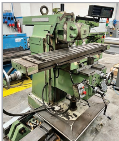
Fresatrice universale MISAL mod. MASTER 727 corse 950x270x400, visualizzata 3 assi
