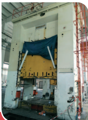
PRESSA MECCANICA ERFURT 500 TON TAVOLA MOBILE 2850 X 1500 mm CORSA 500 mm – LUCE CBRA 1200
