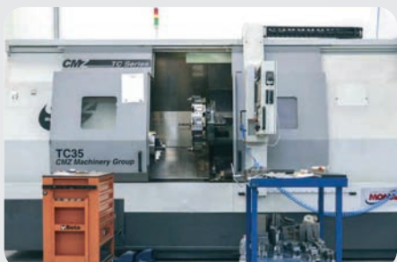
Tornio CMZ MOD. TC35-1350 anno 2009, matricola 154, CNC FANUC 32, diametro massimo di volteggio su basamento 920 mm, diametro massimo di volteggio su carello trasversale 745 mm
