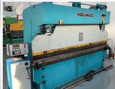
Pressa piegatrice INDUMAC modello POB 80 x 3000 controllo numerico MECOS, 2 assi
