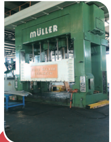
PRESSA OLEODINAMICA MULLER 630 TON TAVOLA 3200 X 2000 mm CORSA 900 mm – LUCE MIN.1900 mm
