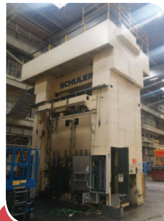
PRESSA MECCANICA LINK DRIVE SCHULER 800 TON TAVOLA MOBILE 3100 X 1900 mm CORSA 700 mm – LUCE CBRA 1200 mm 2 PRESSE DISPONIBILI
