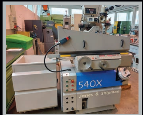
Rettifica tangenziale (Surface Grinding Machine) JONES & SHIPMAN 540 X , 450x170 mm, piano magnetico, aspiratore, OPTIDRESS E Factstor 2, microprocessore per cicli di lavoro. Anno 1999
