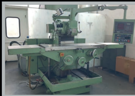
Fresatrice per attrezzeria (Tool Room Milling Machine) ALCOR 220 PLUS , 1050x450x545, visualizzata, presa utensile, CE
