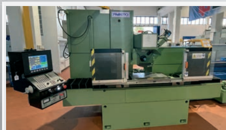
Rettificatrice tangenziale FAVRETTO modello MB 75 CN FAGOR 8055 (NUOVO), dispositivo bilanciatura mola dinamica, volantino elettronico, piano magnetico permanente mm 750 x 400, impianto refrigerante completo di filtro a carta, COMPLETAMENTE REVISIONATA
