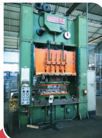
PRESSA MECCANICA OMERA 250 TON TAVOLA 1800 X 1200 mm CORSA 320 mm – LUCE CBRA 710 mm
