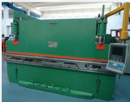
Pressa piegatrice CBC modello T100/40 IS con controllo ESA, 4 assi marchio CE
