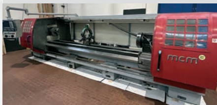
Tornio CNC MCM ATL 400 x 4000 con controllo FAGOR 8055, torretta elettrica DUPLOMATIC 8 posizioni VDI 50, evacuatore trucioli a catena, marchio CE
