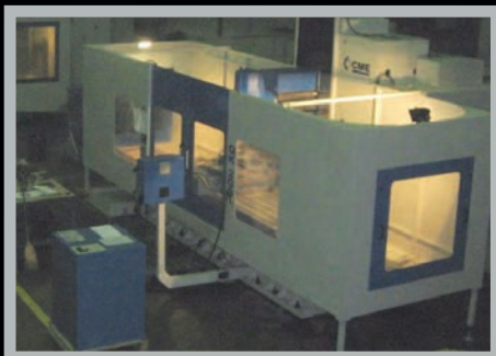
Centro di lavoro (Machining Center) CME QUICK 200 , 5 assi, 2000x1000x1300 mm, tavola diam. 800 mm, testa continua 18.000 rpm, 20 utensili, CNC SELCA 4045
