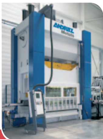
PRESSA MECCANICA KAISER 630 TON TAVOLA MOBILE 3600 X 1700 mm CORSA 400 mm – LUCE CBRA 1000 mm
