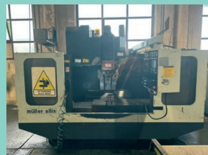
Centro di lavoro KAFO 1100 1100x550x550 6000 giri magazzino 24 utensili, CNC Fanuc
