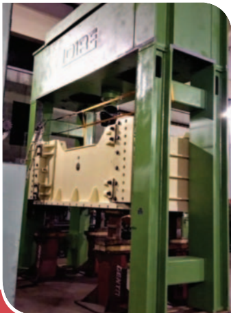
PRESSA OLEODINAMICA LOIRE 2000 TON - 2022 TAVOLA MOBILE 4000 X 1900 mm CORSA 1500 mm – LUCE MAX 1700 mm
