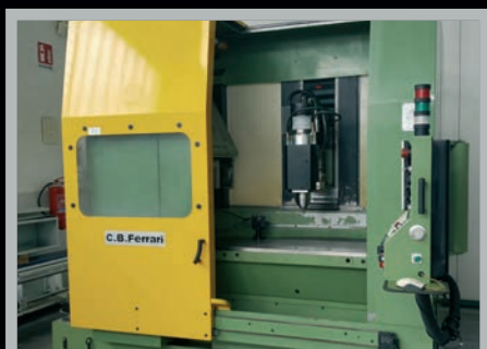
Centro di lavoro (Machining Center) C.B. FERRARI B150 , 850 x 420 x 420 mm, CNC E560, 20.000 rpm, 24 utensili
