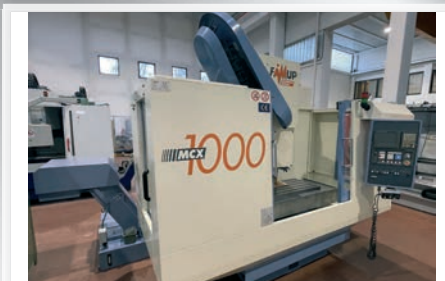
Centro di lavoro verticale FAMUP MCX 1000 eco controllo FANUC 21M, dimensioni tavola mm 1300 x 520, corse X/Y/Z mm 1000/480/470, mandrino ISO 40, velocità rotazione mandrino RPM 0, 8000, magazzino utensili 24 posti, evacuatore trucioli, marchio CE
