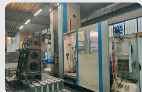
Fresatrice a montante mobile JUARISTI MOD. MX5 anno 2009, CN Selca S4045 PDH, testa orizzontale e verticale indexata 2,5°, corse: X 6000 mm, Y 1250 mm, Z 2500 mm, stazioni portautensili 80, mandrino ISO 50
