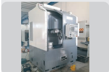
Tornio verticale HYUNDAI MOD. SKT V5 R anno 2008.08, N/S G3196-0393, CNC FANUC 21i TB, capacità di lavoro massima 800 mm, capacità di lavoro sul carrello 560 mm, Ø massimo della macchina 550 mm
