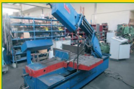
Segatrice a nastro UPAM UP 400 SA, capacità di taglio Ø 420, capacità di taglio rettangolo 620x305H
