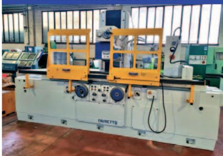
Capacità: 1600x575 mm, Verticale (z): 650 mm, Tavola: 1600x500 mm, Diametro max mola: 406 mm, Diametro foro: 127 mm
