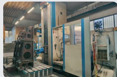
Fresatrice a montante mobile **JUARISTI MOD. MX5** anno 2009, CN Selca S4045 PDH, testa orizzontale e verticale indexata 2,5°, corse: X 6000 mm, Y 1250 mm, Z 2500 mm, stazioni portautensili 80, mandrino ISO 50
