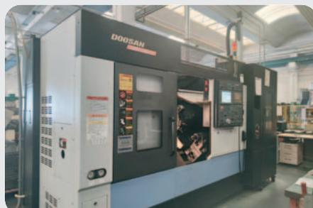
Tornio **DOOSAN MOD. PUMA 240M-GL** anno 2007, N/S P24M3314,  $\varnothing$  tornitura 300 mm, lungh. tornitura 513 mm, pass. barra  $\varnothing$  65 mm, corse: X 205 mm rapido 24 m/min, Z 580 mm rapido 30 m/min
