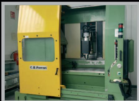
**Centro di lavoro (Machining Center) C.B. FERRARI B150**, 850 x 420 x 420 mm, CNC E560, 20.000 rpm, 24 utensili
