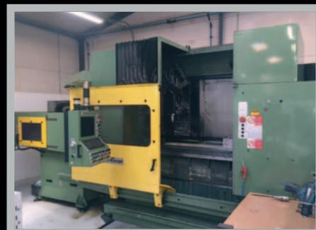
**Centro di lavoro (Machining Center) C.B. FERRARI B18**, 1400 x 520 x 420 mm, CNC E560, 60 utensili, 18.000 rpm, 5 assi
