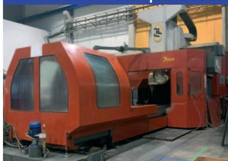
Capacità: 2800x2200x800 mm, Distanza tra i montanti: 1672 mm, 18.000 Rpm, CNC: Heidenhain 530, ATC: 40, Cambio teste
