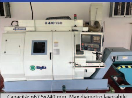
Capacità: ø67,5x240 mm, Max diametro lavorabile
