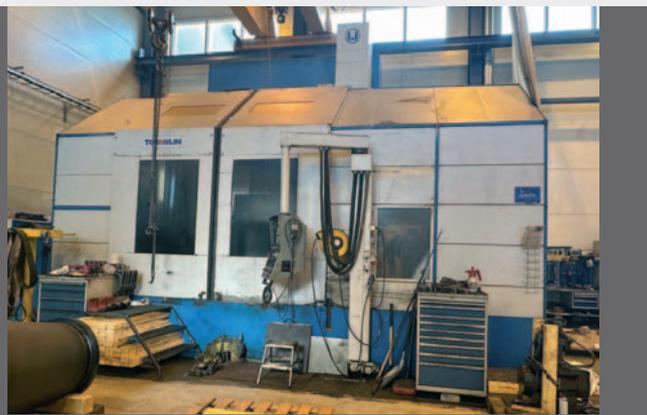
Tornio verticale TOS SKA 25. Diam plateau 2500, diam tornibile 2920, altezza pezzo 940, corsa RAM 1560, cambio utensili 32 posti, cnc SIEMENS 840 C
