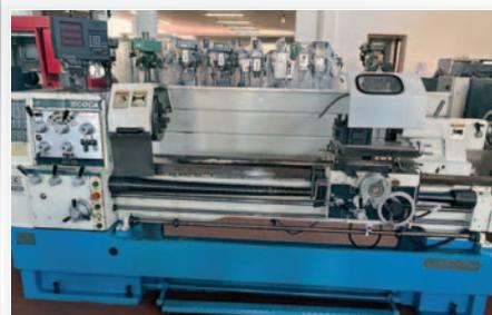
**Tornio parallelo ECOCA modello SJ510 x 1500G** visualizzatore di quote GIVI MISURE montato sui 2 assi, marchio CE
