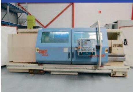
Capacità:  $\varnothing 910 \times 2000$  mm, Max diametro lavorabile da barra: 137 mm, Diametro max sul carro: 585 mm, Cnc: FAGOR 8055TC
