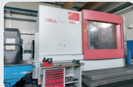
Fresatrice **EMCO-MECOF MOD. UMILL 1800** 5 assi, anno 2016, CNC Heidenhain, corsa asse trasversale 1800 mm, corsa asse longitudinale 2150 mm, avanzamenti 60m/min
