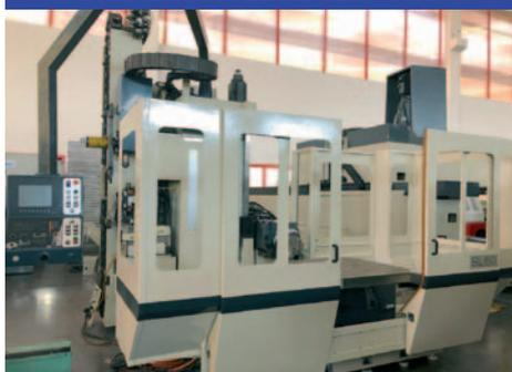
Capacità: 2000x1200x750 mm, Longitudinale (x): 2000 mm, Verticale (y): 1200 mm, Trasversale ram (z): 750 mm, Cnc: Heidenhain TNC425
