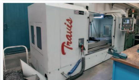
**Centro di lavoro verticale TRAVIS M 1500 L** con controllo FAGOR 8055M, dim. tavola 1500 x 600 mm, corse X/Y/Z 1500/720/880 mm, impianto refrigerante alta pressione attraverso il mandrino, mandrino BT 40, 10000 RPM, mag. utensili RANDOM a 24 posti, evacuatore di trucioli, marchio CE
