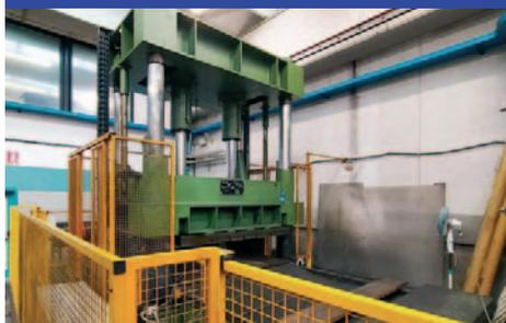
Capacità: 1600x2000 mm, Distanza max tra i piani: 1500 mm, Peso max su piano inferiore: 40000 Kg, Peso max su piano superiore: 15000 Kg, Forza max chiusura: 200 kN
