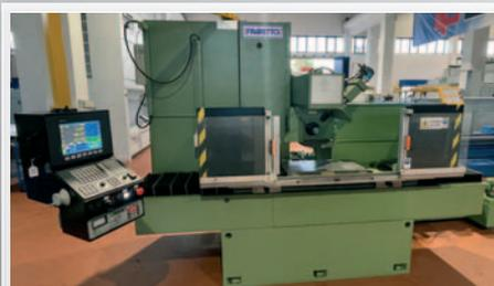
**Rettifica tangenziale FAVRETTO modello MB 75** CN FAGOR 8055 (NUOVO), dispositivo bilanciatura mola dinamico, volantino elettronico, piano magnetico permanente mm 750 x 400, impianto refrigerante completo di filtro a carta, COMPLETAMENTE REVISIONATA
