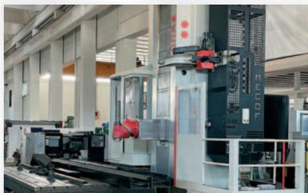
**Fresatrice a m. MECOF AGILE M3 HEIDENHAIN**
