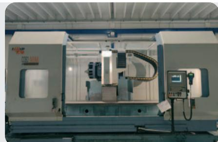
Centro di lavoro a montante mobile **FAMUP-OMZ MOD. COBO MM 3000** anno 2002, CN Selca, tavola: 3450 x 600 mm, corse: X 3000 mm, Y 600 mm, Z 500 mm, mandrino ISO 40, vel. 40-8000 giri/min, potenza 11 Kw
