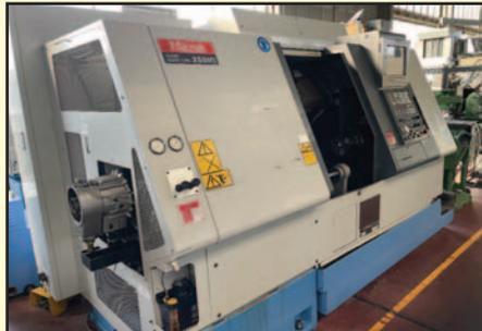
Tornio a controllo numerico MAZAK SQT 250 MS
