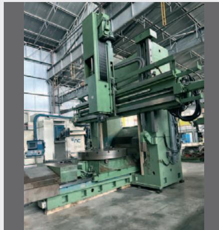
Tornio verticale PENSOTTI NDM 160, ASSE C, ASSE Y, utensili motorizzati, diam plateau 1800, diam tornibile 2600, altezza tornibile 1800 (2200), nr 2 cambio utensili a tornire e a fresare, capacità di fresatura 2000 x 2000, cnc ICEM
