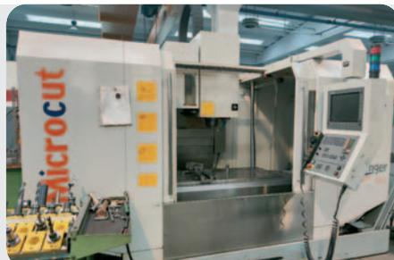
Centro di lavoro verticale **MICROCUT MOD. VM-1300** anno 2005, CNC Heidenhain 530, tavola 1500 x 660 mm, corse asse X 1300 mm, asse Y 660 mm, asse Z 680 mm, mandrino ISO 40 DIN69871, velocità 10000 rpm, pot. 15 Kw
