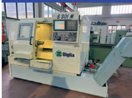
Capacità:  $\varnothing 45/220 \times 380$  mm, Cnc: Fanuc 18, Torretta 12 posizioni
