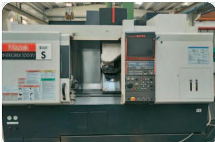
Tornio **MAZAK MOD. INTEGREX 100-IVS** anno 2009-12, ore di taglio 3350, CN Mazatrol Matrix, passaggio barra  $\varnothing$  61 mm, corse: X 410 mm, Y 140 mm, Z 805 mm, mandrino A2-5, vel. 6000 giri/min
