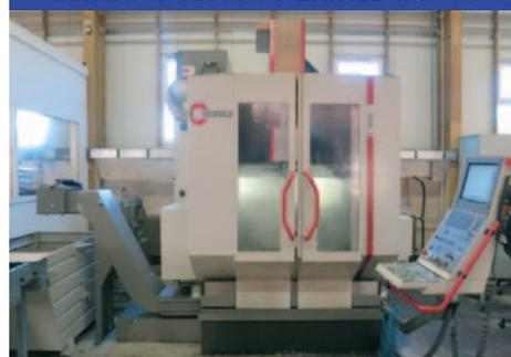
Capacità: 800x600x500 mm, Rotazione tavola (b): 360.000 °, Cnc: Heidenhain TNC530, Velocità rotazione: 10000 Rpm, ATC: 87
