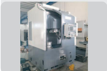
Tornio verticale **HYUNDAI MOD. SKT V5 R** anno 2008.08, N/S G3196-0393, CNC FANUC 21i TB, capacità di lavoro massima 800 mm, capacità di lavoro sul carrello 560 mm,  $\varnothing$  massimo della macchina 550 mm
