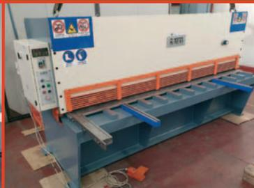
Cesoia GATTI 3000x4 mm. idraulica registro posteriore motorizzato
