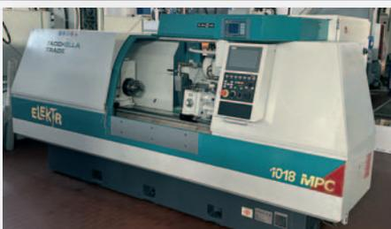
**Rettifica per esterni TACCHELLA mod. ELEKTRA 1018 MPC** h. punte 180 mm, distanza punte 1000 mm, sistema orientamento testa portamola MANUALE, doppia mola per esterni, sistema di comando gestito da microprocessore, impianto refrigerante con vasca e pompa con filtro a carta, CE
