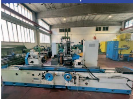
Capacità: 2000x460 mm, Anno: 1998 (CE), Altezza punte: 230 mm, Diametro mola: 500 mm
