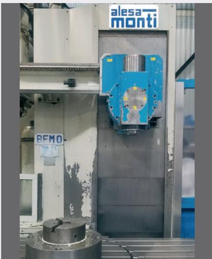
Fresatrice banco fisso MONTI BFMO TGF, testa automatica, con tavola girevole integrata, corse: 2000 x 800 x 1000, tavola girevole diam 800 mm, cambio utensili 30 posti, 4000 giri/min, cnc HEIDENHAIN TNC 530
