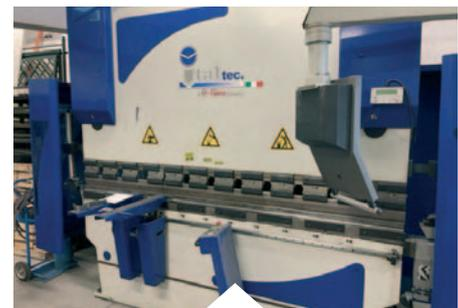
PRESSA PIEGATRICE IDRAULICA SINCRONIZZATA
