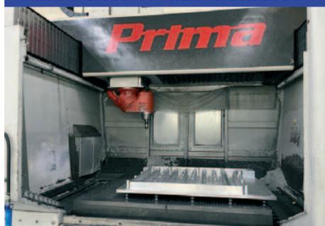
Capacità: 1650x1400x800 mm, Tavola: 1500x1800 mm, Portata: 10000 Kg/mq, ATC: 24
