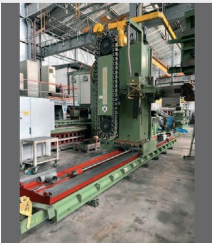
Fresatrice a montante mobile LAZZATI HB 2M, testa aut., corse: 6000 x 950 x 2000, tavola rototraslante 2400 x 1800, cambio utensili, piani stolte, cnc DI ELECRON Z 32
