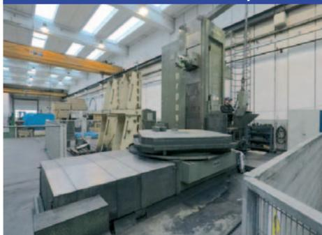
Capacità: 8000x3000x1250 mm, Cnc: SELCA 4045PD,
