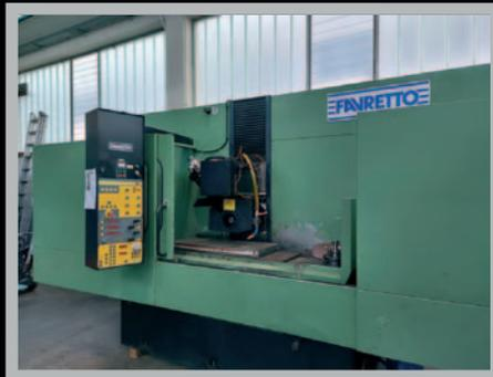
**Rettifica tangenziale (Surface Grinding Machine) FAVRETTO MB 100 Auto**, 1200x600 mm, inverter mola, piano elettropermanente, interfaccia Favretto Auto-control con cicli di lavoro, Bilanciatore mola semiautomatico
