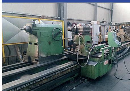
Distanza punte: 12.000 mm, Diametro sul carro: 1800 mm, CNC: ECS 2801
