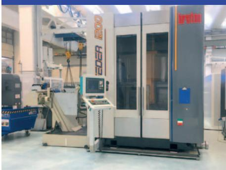
$\varnothing$  1200x1000x600 mm, Cnc: SIEMENS 840DSL, Velocità rotazione: 24000 Rpm, Dimensione (lxwxh): 1500x1000 mm, Peso totale macchina: 18000 Kg
