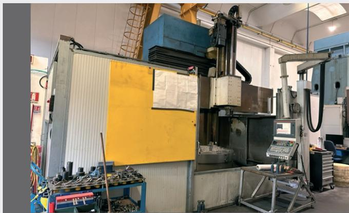
Tornio verticale TOS SKA 20, asse C, utensili motorizzati, diam autocentrante idraulico 2000, diam tornibile 2300, altezza pezzo 1470, cambio utensili 30 posti, cnc D.E. Z 32
