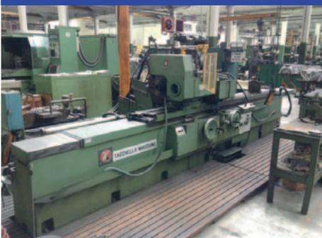
Capacità: 550x2100 mm, Altezza punte: 280 mm,
