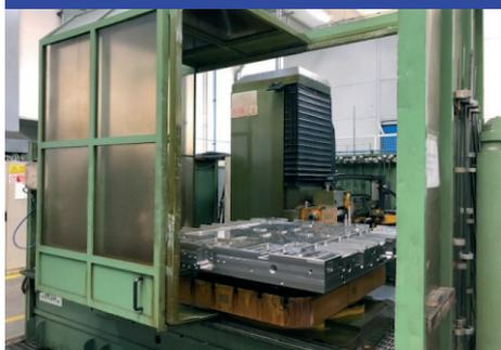
Capacità:  $\varnothing$  5-25 mm - 2350x1150x300 mm mm, Profondità di foratura (v): 1500 mm, Cnc: Selca S3045, Superficie: 1500x1200 mm, Portata: 20000 Kg
