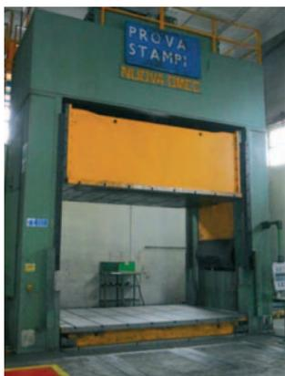
Pressa idraulica OMEC 400 ton
