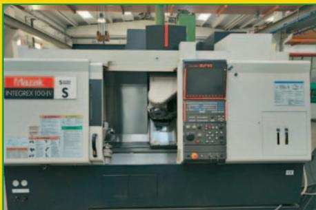
Tornio MAZAK mod. INTEGREX 100-IVS, anno 2009-12, CN Mazatrol Matrix, passaggio barra Ø 61 mm
