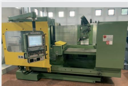
**Centro di lavoro verticale CB FERRARI modello A17** con controllo SELCA S4000, corse XYZ 1050/520/420 mm, testa tiltante +/- 90°, ISO 40, RPM 10-5000, magazzino utensili a 21 posti, righe ottiche sui 3 assi, marchio CE, COMPLETAMENTE REVISIONATA COME NUOVA
