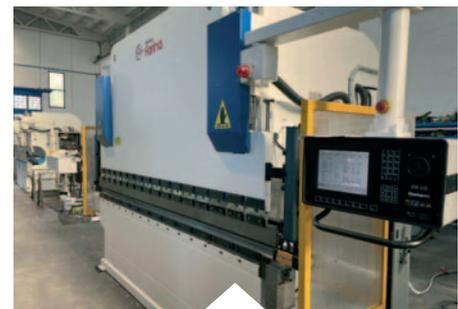
PRESSA PIEGATRICE IDRAULICA SINCRONIZZATA
