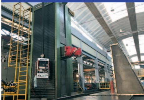
Montante mobile, 13000x3500x1250 mm, idrostatica, CNC NUM 1060, testa TA110 ISO50 indexata 2,5°, refrigerante interno/esterno alta pressione
