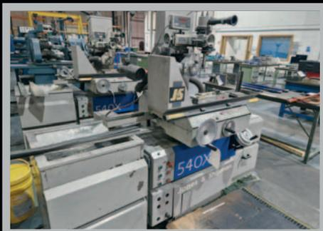
**Rettificatrice tang. (Surface Grinding Machine) JONES & SHIPMAN 540 X**, 450x170 mm, piano magnetico, aspiratore, OPTIDRESS E Factstor, microprocessore per cicli di lavoro, Anno 1997
