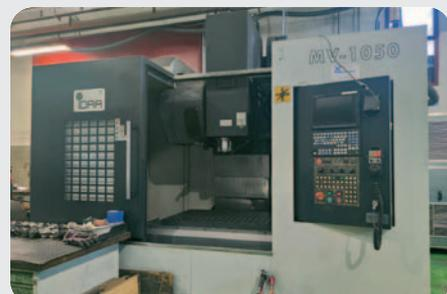
Centro di lavoro verticale **L.K. MACHINERY MOD. MV-1050** anno 2013-12, CN Mitsubishi M700, tavola 1250 x 600 mm, corse: X 1050 mm rapido 10 m/min, Y 550 mm rapido 10 m/min, Z 560 mm rapido 10 m/min
