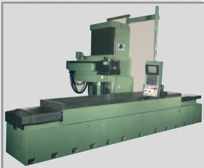
Fresatrice alesatrice a banco fisso **FIL F.A. 1000** tavola con movimento long. montante mobile, cnc Heidenhain, corse: long. tavola mm 3000, verticale slittone mm 2000, trasv. montante mm 1000, trasv. slittone mm 800, sup. lavoro della tavola mm 3500x1000
