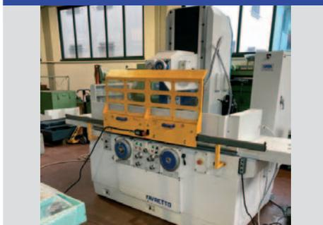
Capacità: 1300x575 mm, Spessore rettificabile max: 400 mm, Velocità traslazione: 2-35
