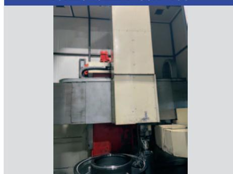
Capacità: 1700x1400 mm, Portata max pezzo: 10000 Kg, Cnc: ECS 2400, Diametro piattaforma: 1400 mm
