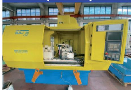
Capacità:  $\varnothing$  300x800 mm, Altezza punte: 150 mm, Diametro rettificabile max: 300 mm, Cnc: FANUC 210i
