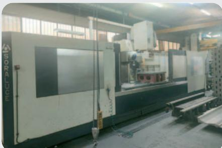
Fresatrice a banco fisso **SORALUZE MOD. TA-35°** anno 2008, matricola 2833, CNC Heidenhain 530, peso ammesso sulla tavola 2.500 Kg/m<sup>2</sup>, corse: vert. 1250 mm, long. 3500 mm, RAM trasv. 1000 mm
