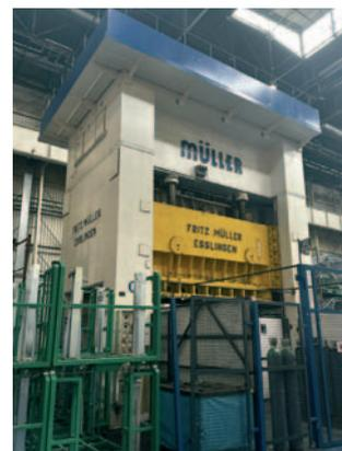
Pressa idraulica MULLER 1.500 ton.
