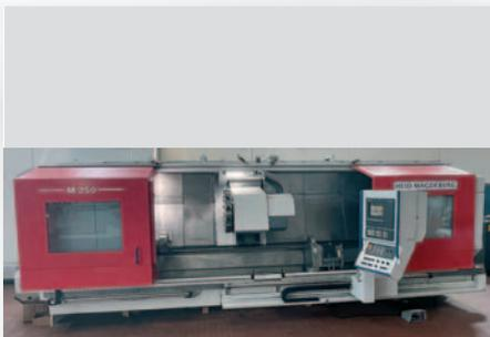
**Tornio CNC MAGDEBURG modello M250** controllo SIEMENS 840C, Ø max tornibile / lunghezza massima tornibile 470 / 3030 mm, attacco mandrino ASA8°, foro mandrino 90 mm, mandrino autocentrante diametro 315 mm, torretta 12 posizioni per ut. motorizz. VDI50, asse C su mandrino principale, lunetta idr. SLU 5, con presa da 50 a 310 mm, marchio CE
