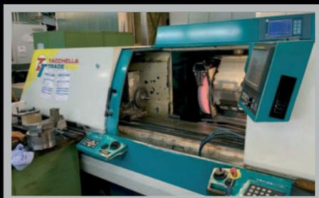
**Rettifica cilindrica (Cylindrical Grinding Machine) TACCHILLA ELEKTRA EVO 1018 MPC**, h punte 180 x 1000 mm, mandrino int. 30.000 rpm, vasca filtraggio a carta, balance system, interfaccia EVO-Fanuc 21i, 2004
