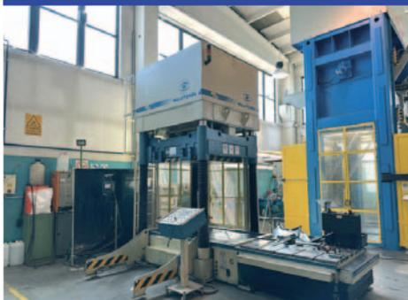
Capacità: 1400x1200 mm, Distanza tra le colonne: 1300x1540 mm, Distanza max tra i piani: 1100 mm, Distanza min tra i piani: 250 mm
