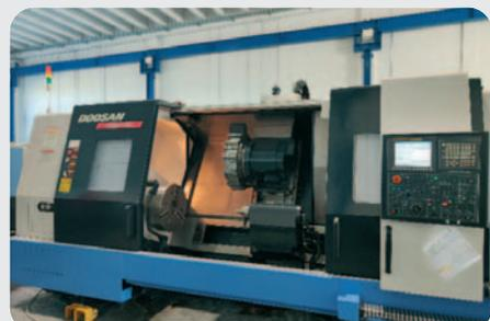
Tornio **DOOSAN PUMA 500** anno 2013.07, CNC FANUC, max  $\varnothing$  rotante sul banco mm 900, max  $\varnothing$  rotante sul carro mm 630, max tornibile sul banco mm 700, max lunghezza tornibile mm 1575
