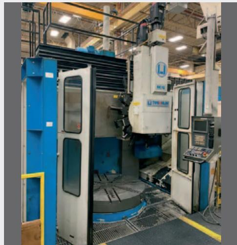
Tornio verticale TOS SKIQ 16, asse C, utensili motorizzati, diam autocentrante idraulico 1600, diam tornibile 1800, cambio utensili 15 posti, cnc FANUC 16i-T
