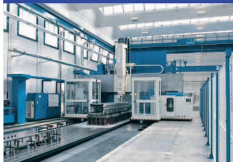
Gantry,  $\varnothing 16000 \times 2500 \times 1625$  mm, Cnc SIEMENS 840 D, Mandrino: 35 Kw. 3000 Rpm CONO: ISO50, ATC 60, Testa birotativa TU35, Testa 90° tipo TS35SP, Testa verticale TV35, Refrigerante: interno + 4 ugelli esterni
