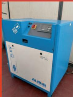
Compressore a vite silenzioso a velocità variabile inverter ALMIG FLEX 22, m3/min. 1,09-3,81, BAR 5-13, HP 30
