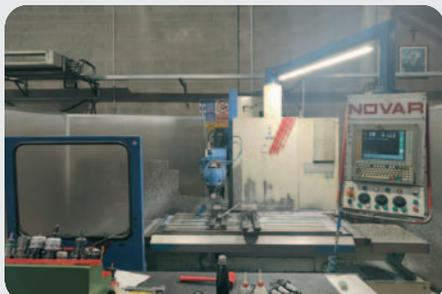
Fresatrice **NOVAR MOD. PARTNER 1700** anno 1996, CN SELCA 3045, tavola 1700 x 700 mm, peso ammesso 3000 Kg, corse: X 1500 mm, Y 700 mm, Z 800 mm, rapidi 10 m/min, avanzamenti lavoro 4 m/min
