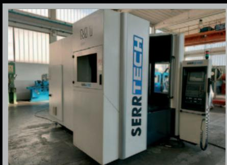
**Centro di lavoro (Machining Center) SERRTECH M1**, 1000 x 600 x 600, 30 utensili, 12000 rpm, HEIDENHAIN i530
