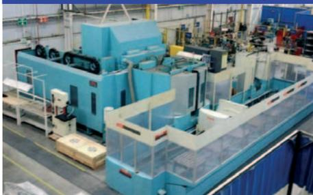
corse 1875x1060x1345 mm, capacità  $\varnothing 1250 \times 1250$  mm, anno 2003, CNC Mazatrol PC-FUSION 640M 5X E-Tower, ATC160, Pallettech 8+2, mandrino nuovo 2015, tornitura e fresatura, iperaccessoriata
