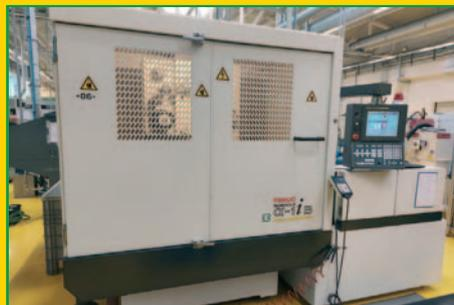
Elettroerosione a filo FANUC Alpha 1-iB, capacità 550x370x310 mm, CNC Fanuc 180iS, WB
