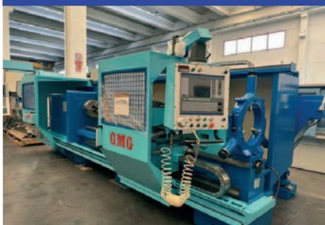
Capacità: 420x3000 mm, Anno: 2004, ASSE C, Motorizzati, Torretta 12 posizioni, CNC: ECS 1400D
